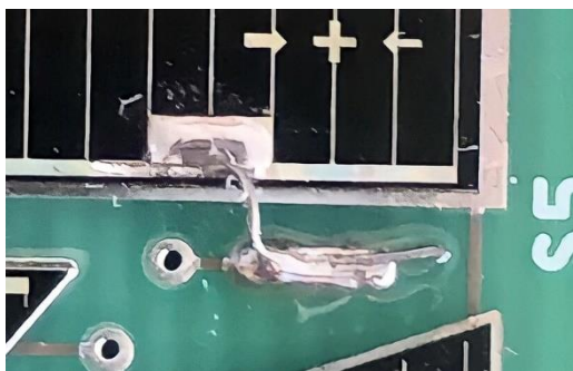
Obr. 28: Detail kontaktu mezi katodou a deskou
