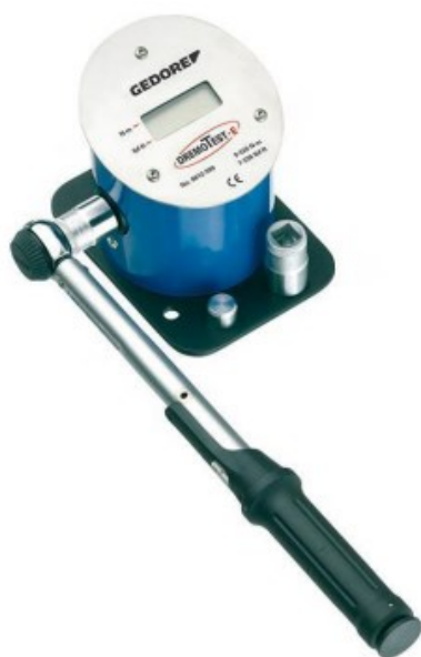
Obrázek 31 - Měřicí přístroj pro kontrolu momentového klíče
