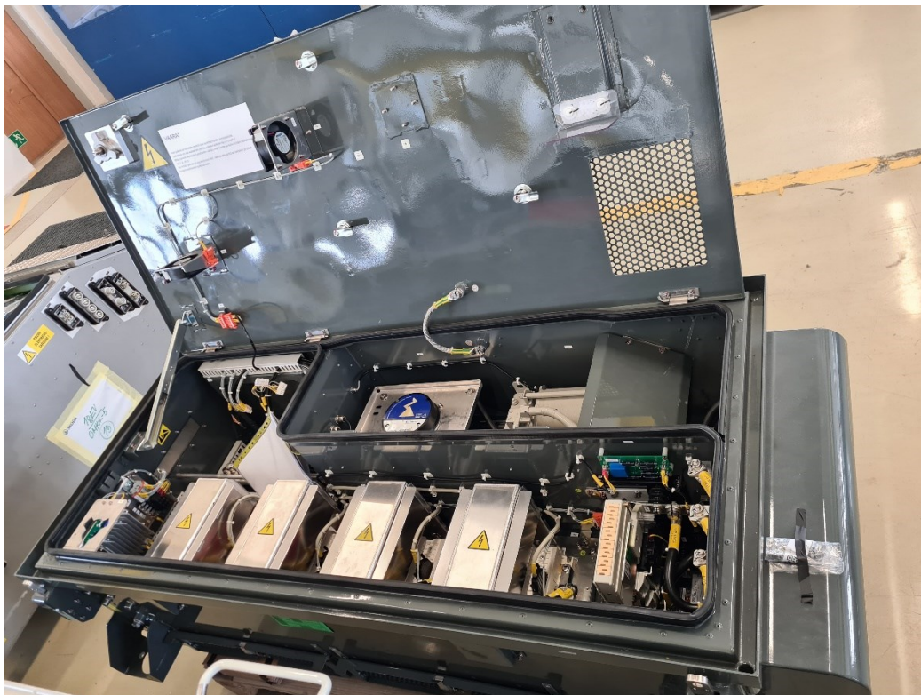
Obrázek 8 - Kontejner (střešní jednotka pro tramvaje)
