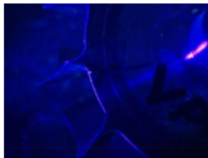
Obr. 4 - Zobrazení vady při kapilární zkoušce [4]
