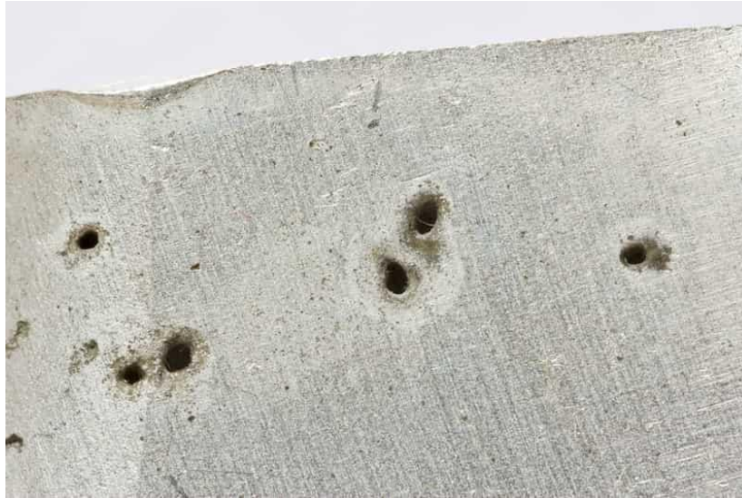
Obr. 3: Příklad bodového korozního napadení [13]
