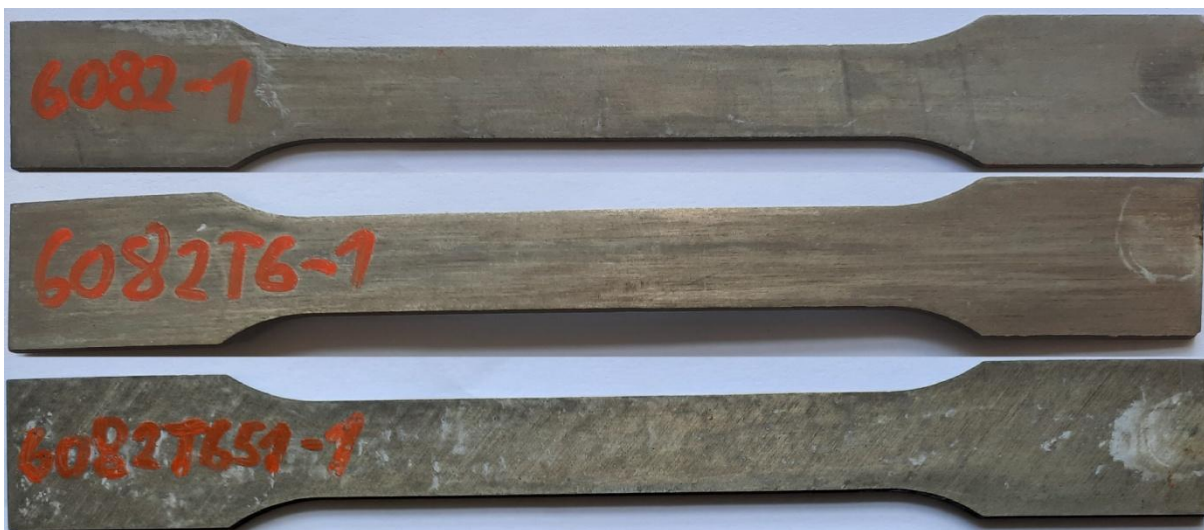
Obr. 18: Korozní napadení vzorků po 504 hodinách expozice, 1 kus od každého stavu TZ
