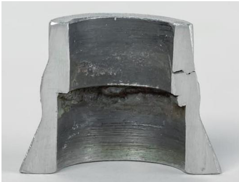
Obr. 6: Součást zničená v důsledku korozního praskání [13]
