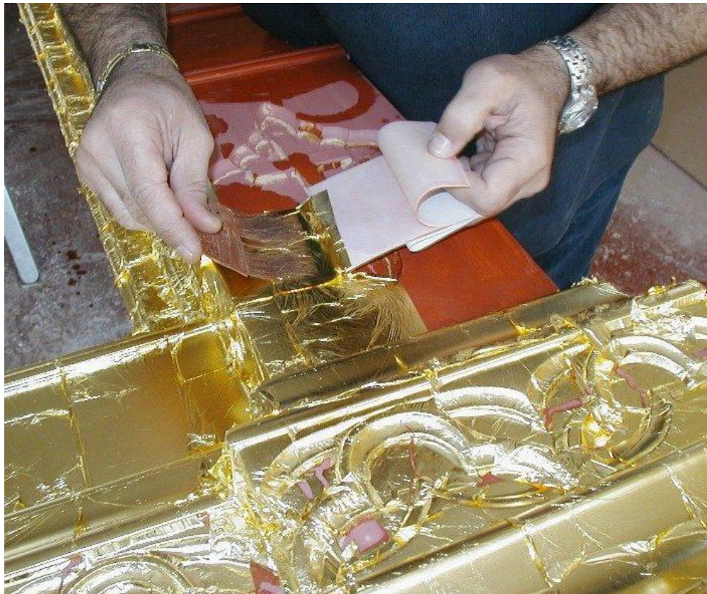
Obr.4: Pozlacování plátováním [Obr.4]
