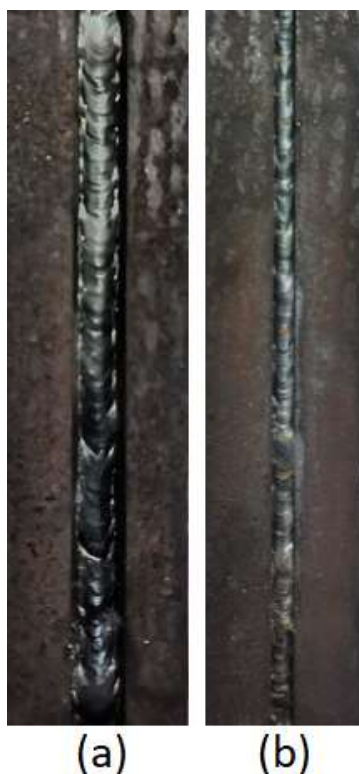
Obrázek 18 Svařenec 2 (a) Vrchní strana (b) Spodní strana
