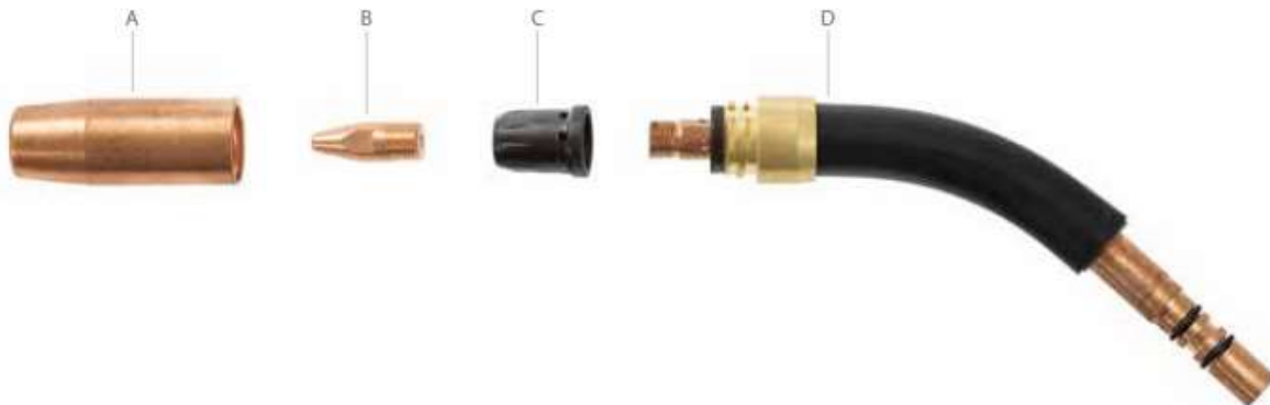
Obrázek 6 Hořák MIG. (a) Plynová tryska (b) Proudová kontaktní tryska (c) Držák trysky (d) Plynová hubice [14]
