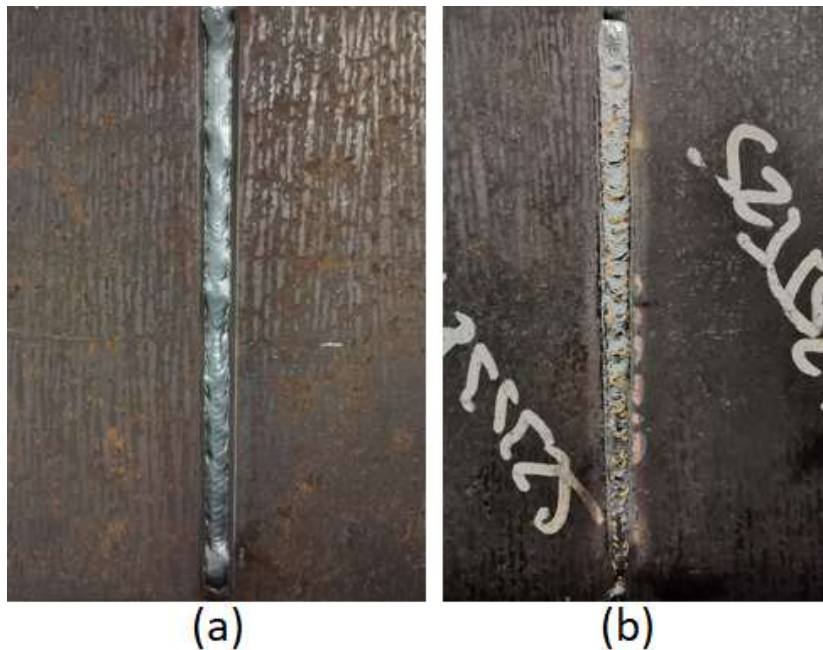
Obrázek 17 Svařenec 1 (a) Vrchní strana (b) Spodní strana
