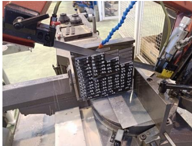
Obrázek 21 - Odřez vzorků na pásové pile
