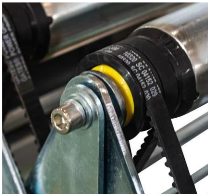
Obrázek 5.7 Pohon ozubeným řemenem [30]
