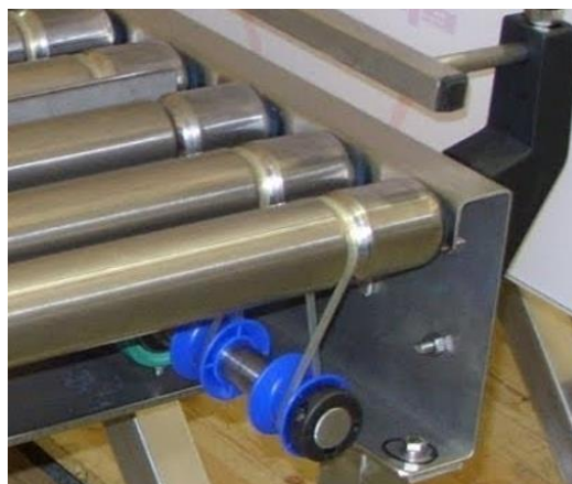
Obrázek 5.10 - Pohon kruhovým řemenem podélnou hřídelí [1]
