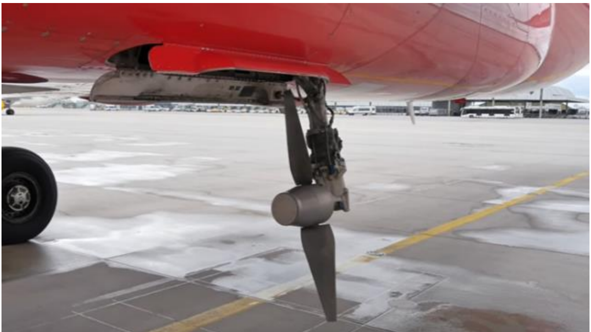
Obr. 12 Pomocná vzduchová turbína
