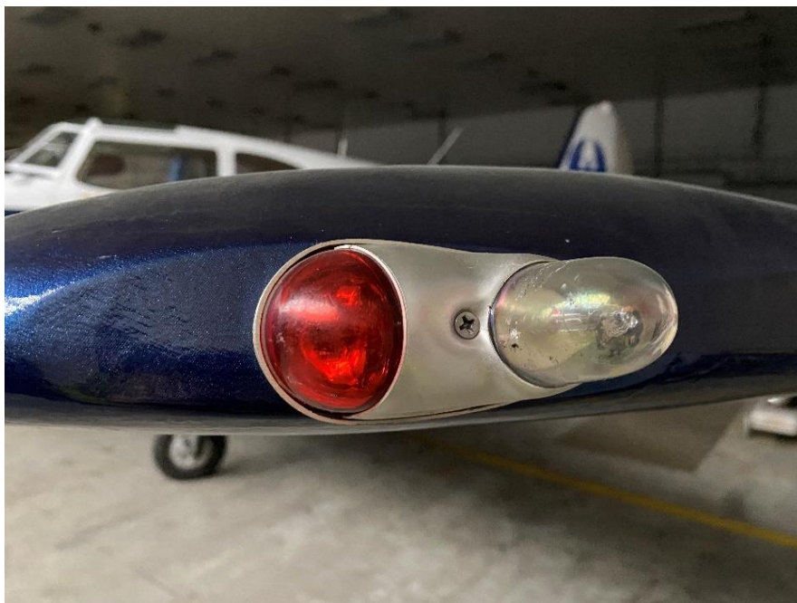
Obr. 6 Navigační a zábleskové světlo (Jak-18T)
