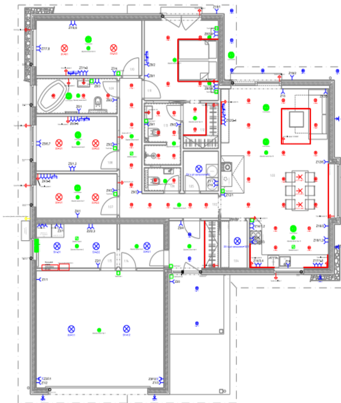
Obr. 9 Elektroinstalace s využitím systému Loxone
