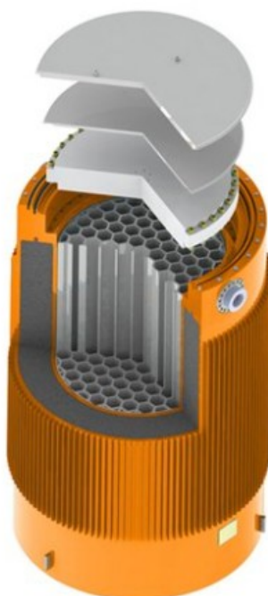
Obr. 2.8 Řez obalu CONSTOR [9]
