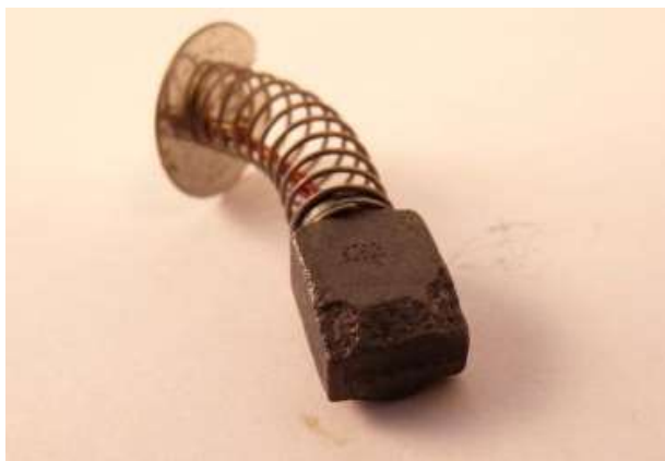
Obr. 12 Opálený kartáč stejnosměrného motůrku (převzato [23])
