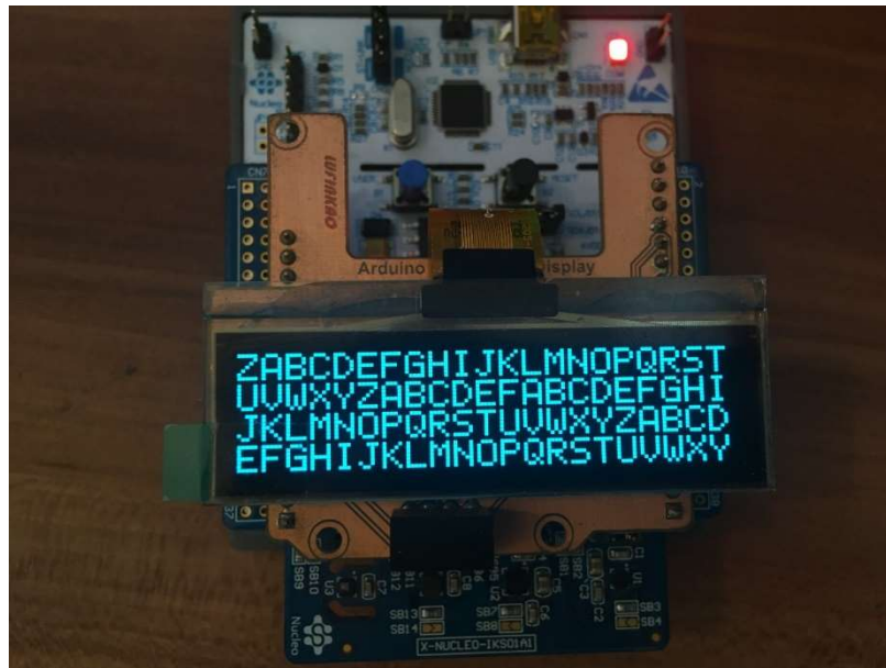
Obr. 15 Zobrazovací funkce na panelu o rozlišení 128 x 32 s SPI
