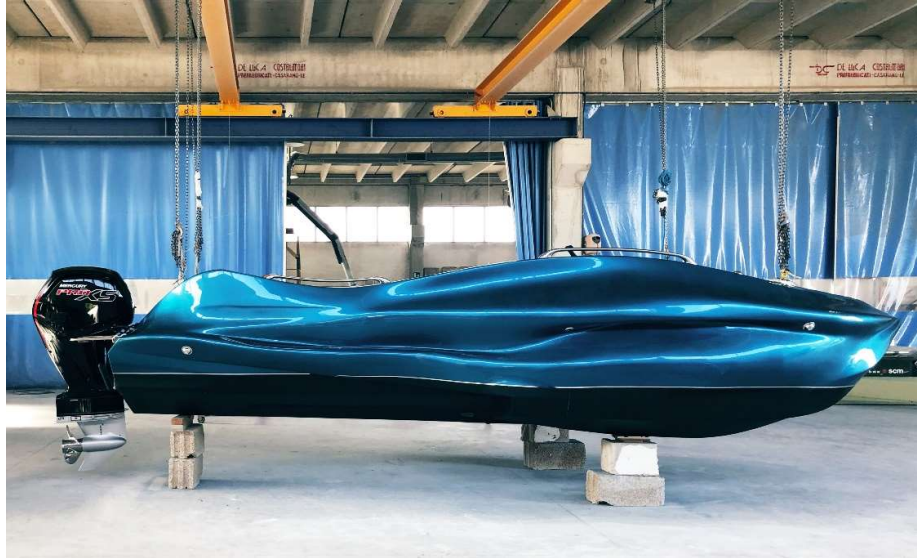
Obr. 5.: 3D vytištěná loď „MAMBO“ (převzato z [5])
