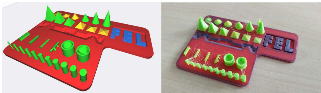
Obr. 29.: Testovací destička s jehlánky a válečky jak měla vypadat (vlevo) a hotový výtisk (vpravo)
