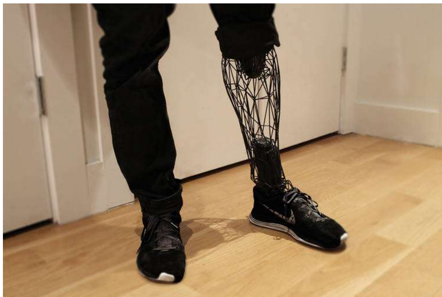
Obr. 8.: 3D vytištěná protéza tvořená jedním kusem (převzato z [14])
