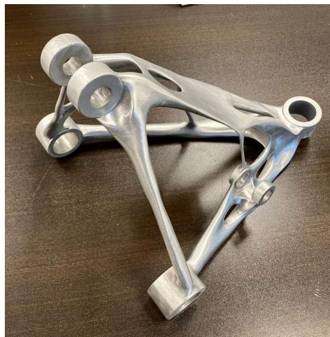
Obr. 3.: Rameno zavěšení automobilu Czinger 21C inspirované přírodním designem (převzato z [2])
