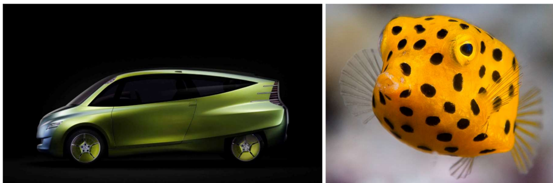
Obr. 12.: Mercedes Bionic Concept inspirovaný Havýšem žlutohnědým (převzato z [41])
