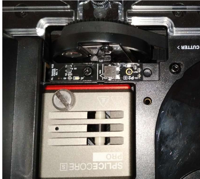
Obr. 33.: Lokace zničeného čidla s viditelným zamáčknutým jazýčkem
