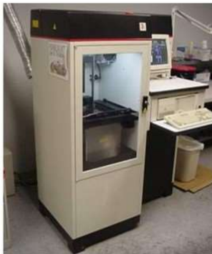
Obr. 6.: První 3D tiskárna "Apparatus" od společnosti 3D Systems z roku 1992 (převzato z [7])
