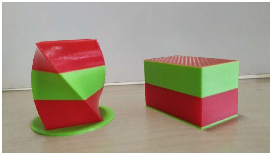
Obr. 25.: Výtisk (vlevo) a odpadní materiál vzniklý při jeho tisku (vpravo)
