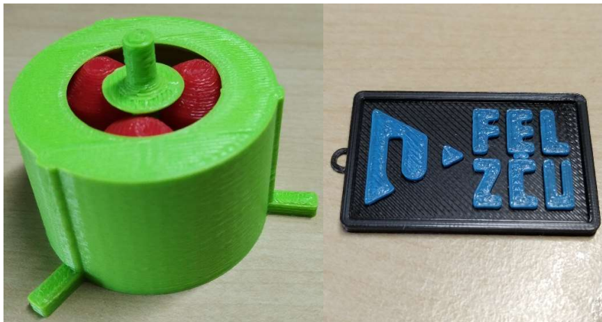
Obr. 27.: Mnou vymodelované a vytištěné válečkové ložisko (vlevo) a reklamní přívěšek (vpravo)
