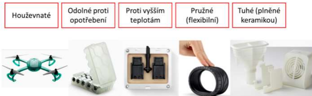
Obr. 37.: Rozdělení technických fotopolymerů s příkladem aplikace (převzato z [26])
