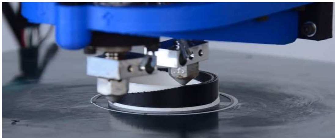
Obr. 22.: Detail tiskové hlavy se dvěma extrudéry (převzato z [30])
