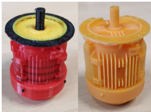
Obr. 50.: Porovnávací model asynchronního motoru z FDM (vlevo) a SLA (vpravo) 3D tiskárny
