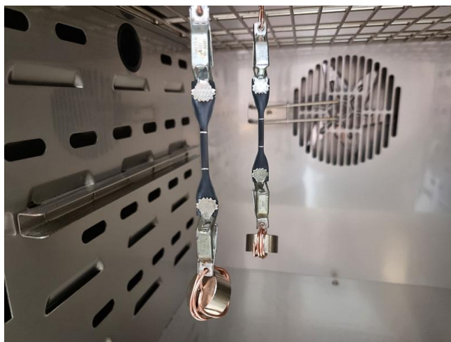
Obr. 32: Upnutý vzorek v peci a zatížený zaváží [19]
