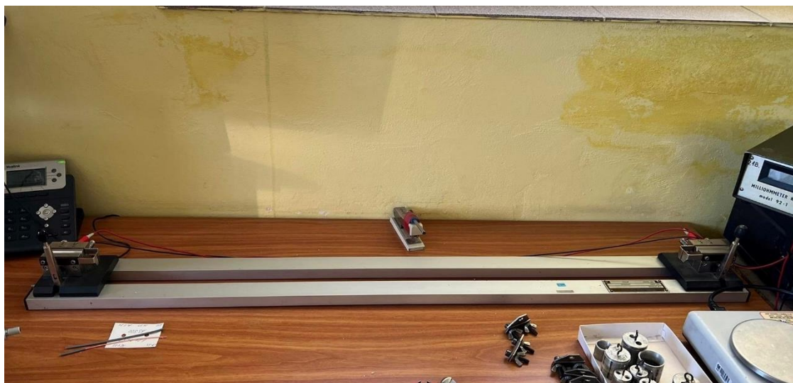
Obr. 12: Zařízení pro měření odporu jádra
