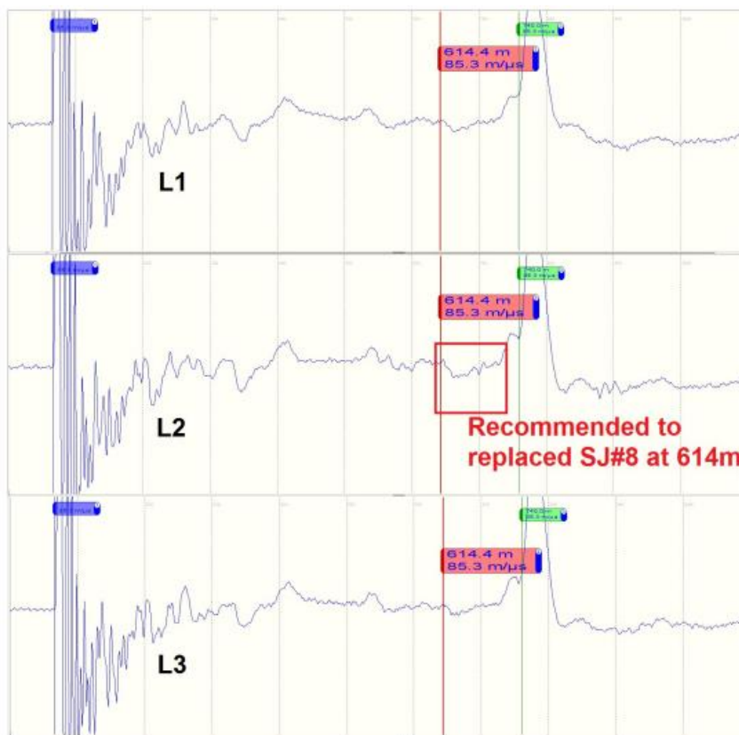
Obr. 27: Lokalizace vlhkých spojů pomocí TDR [22]
