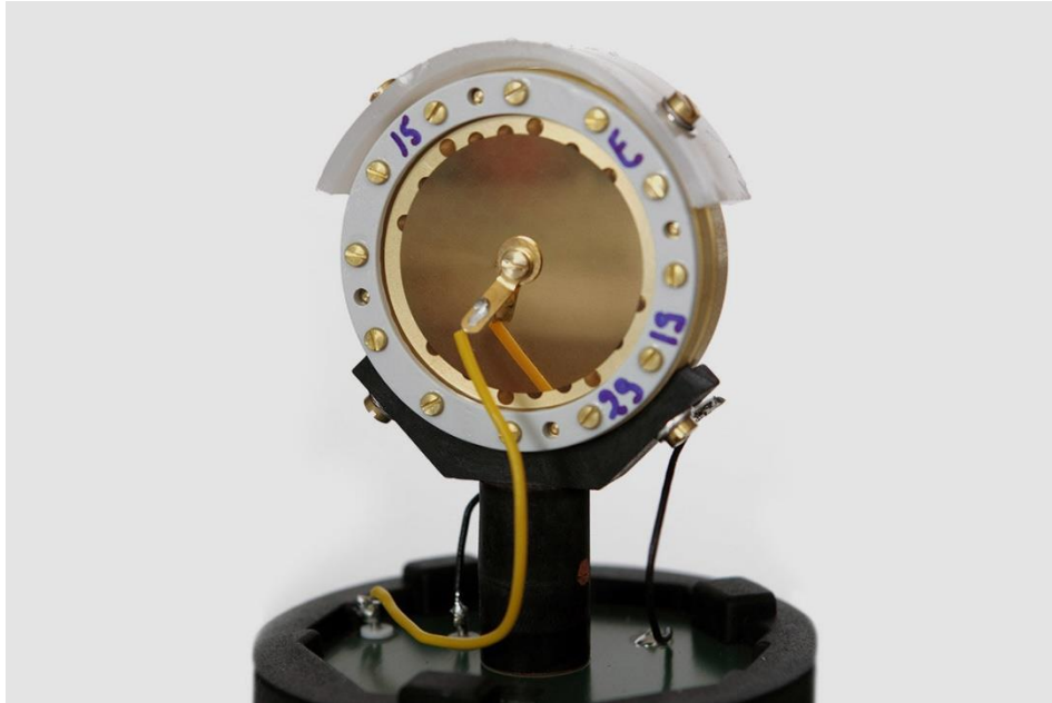
Obrázek 3 Kondenzátorová mikrofonní kapsle se zlatem naprášenou mylarovou membránou. [5]
