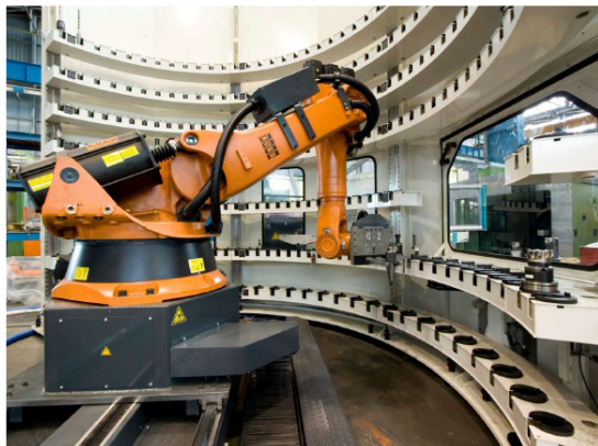
Obrázek 8 - robotické rameno, uvnitř cylindrického zásobníku nástrojů
