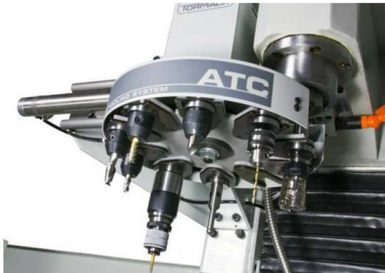
Obrázek 4 - Pick-Up zásobník v poloze výměny nástroje pod vřetenem stroje
