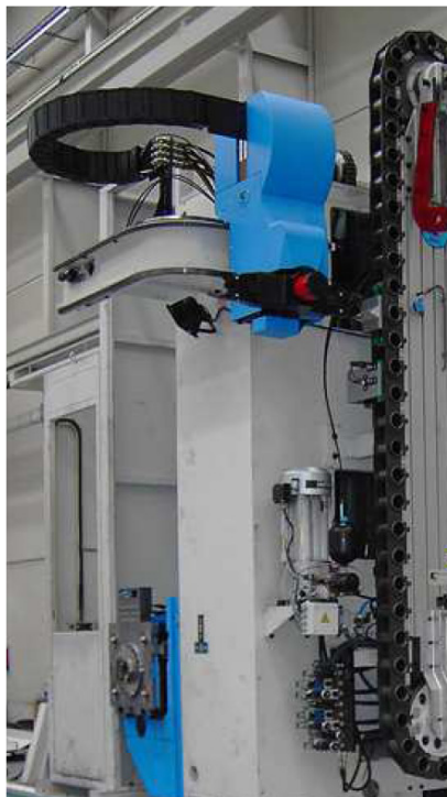
Obrázek 6 - princip řetězového zásobníku s manipulátorem a upínačem u horizontální vyvrtávačky
