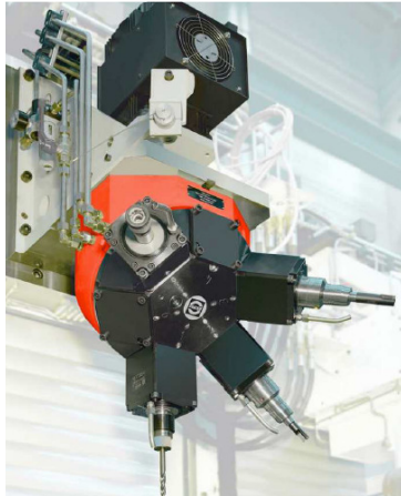
Obrázek 3 - vřetenová hlava se 4ks nástrojů
