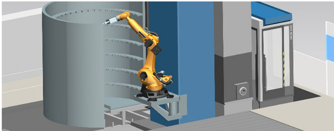
Obrázek 13 - robotické rameno umístěné na sloupu stroje HCW
