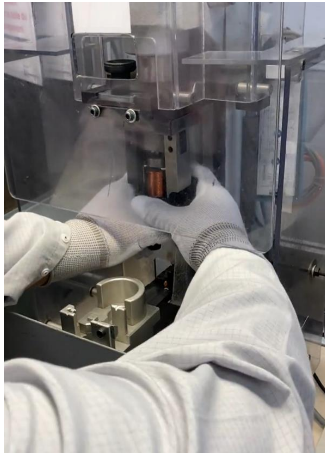
Obrázek 7 - problém vtažení výrobku do zakrytované části zařízení při vylisovací operaci stávajícího řešení
