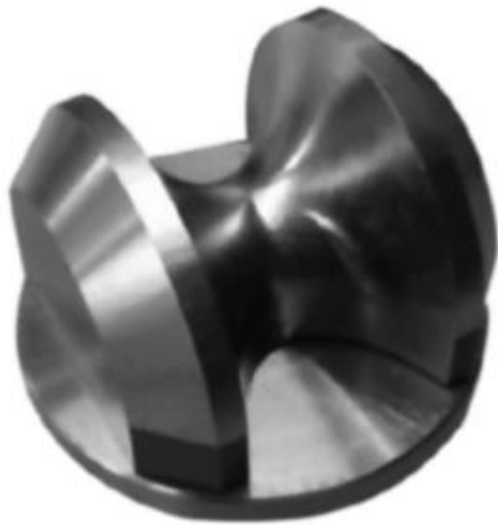
Obrázek 15 – Diabolo tažník (vlevo), diagram hlavních deformací (vpravo) [7]
