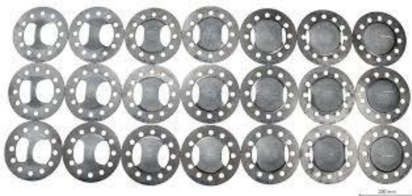
Obrázek 10 – Náhled vzorků pro Nakajima test [16]
