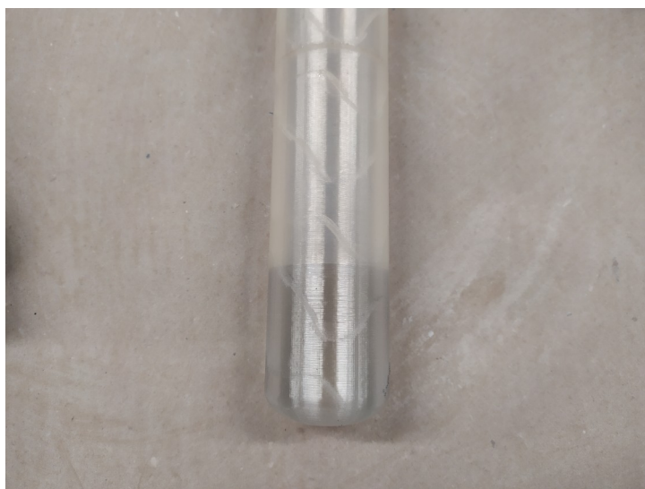
15. vlnky a kazy u průhledného filamentu; 3D tisk; autor: Zdeňka Minářová; 2022
