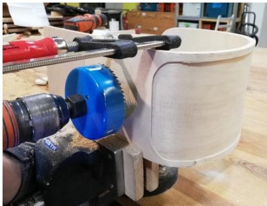
Obrázek 38 – zhotovení výrobku – vytvoření otvoru vykružovací pilou
