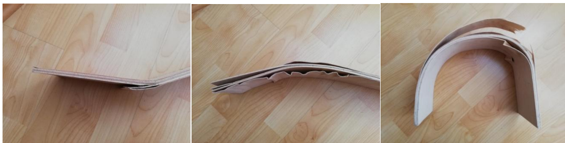
Zleva: Obrázek 23 – rešerše materiálu – zkouška uhnutí překližky (2)
