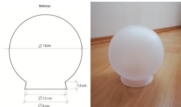
Zleva: Obrázek 32 – zhotovení výrobku – technický výkres skleněné baňky
