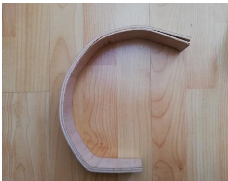
Obrázek 22 – rešerše materiálu – zkouška uhnutí překližky (1)
