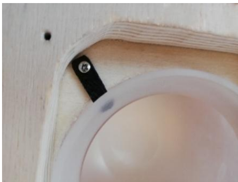
Obrázek 41 – zhotovení výrobku – systém uchycení skla
