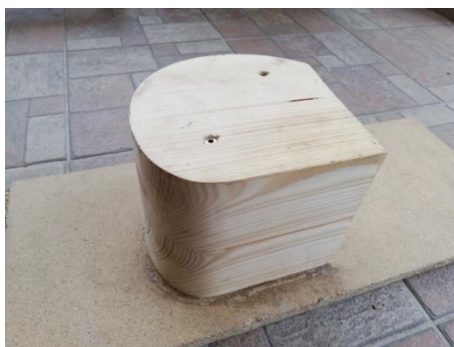
Obrázek 34 – zhotovení výrobku – šablona na ohýbání
