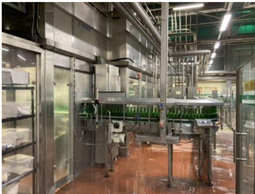
Obr. 14: Vstup prázdných lahví do Plniče [27]
