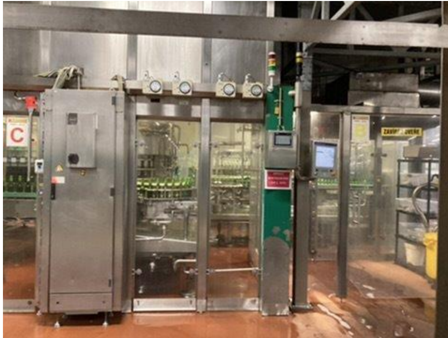
Obr. 15: Proces plnění lahví na Plniči [27]
