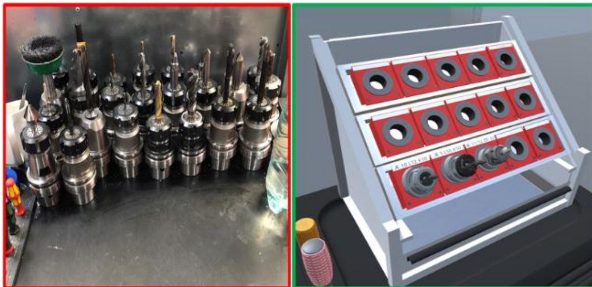
Obrázek 44: Současný (vlevo) a nový (vpravo) stav uspořádání upínačů [autor]
