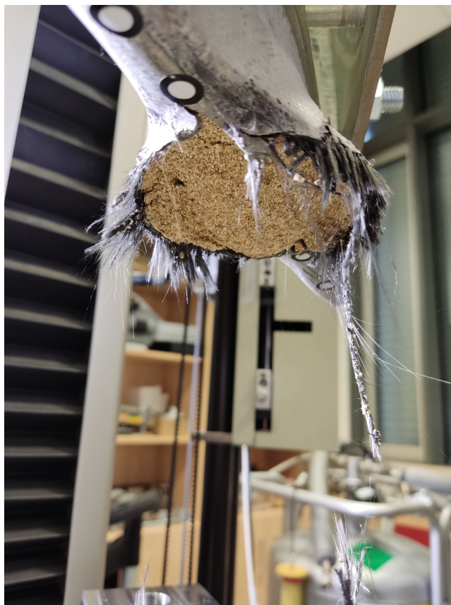
Obrázek 11: Porušení lopatky č. 2 při dalším zatížení až do úplné destrukce. [15].
