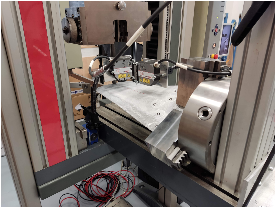
Obrázek 13: Sestava experimentální ohybové zkoušky lopatky
