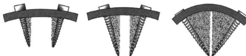
Obrázek 3.5: Schématické znázornění účinku triangulace [39].
