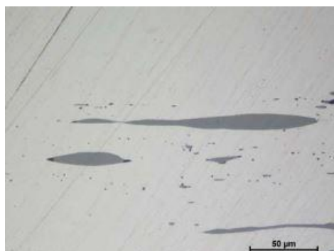
Obr. 12: Silikátový typ vměstku [18]
