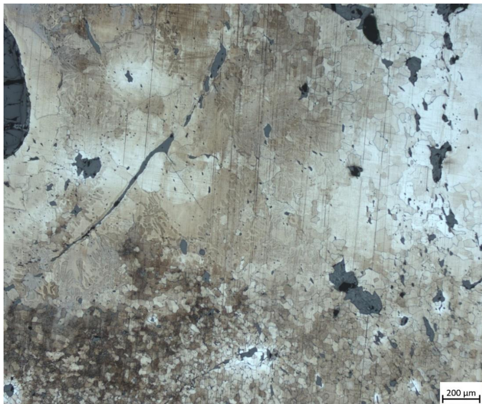
Obr. 70: Hrot č. 4 pozůstatky dendritické struktury (100x, barevné leptání Klemm)
