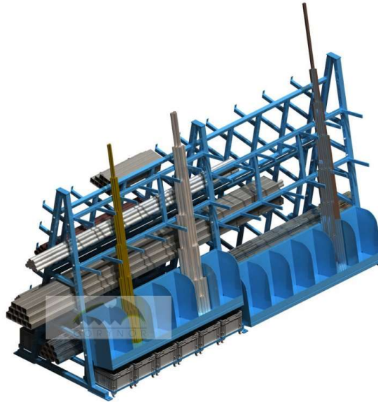
Obrázek 12 - Regál na vertikální uložení tyčí [12]
