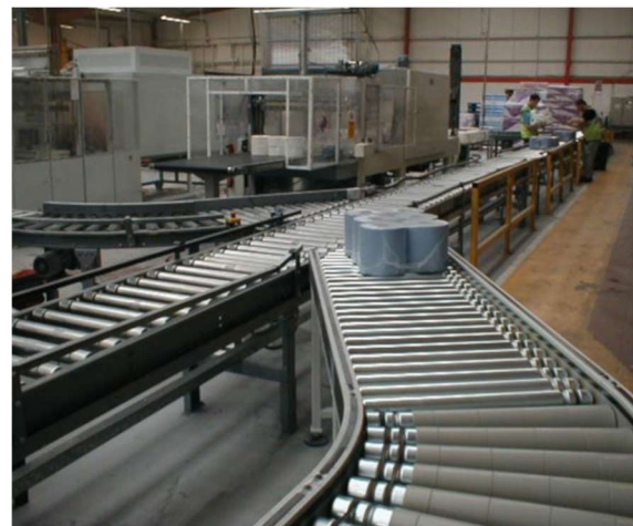
Obrázek 2 - Válečkový dopravník – pohyb po vázané dráze [2]
