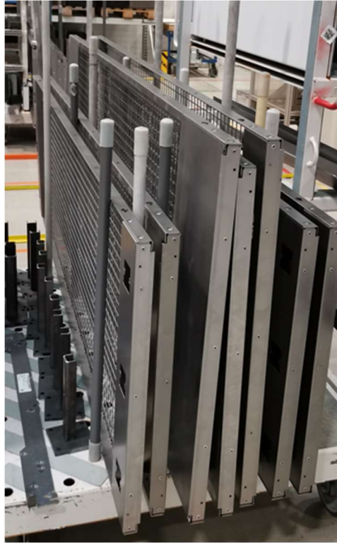
Obrázek 14 - Ukládání deskového materiálu mezi opěrné tyče
