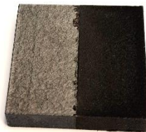
Obr. 35 Vytisknutý vzorek s nanesenou termografickou barvou
