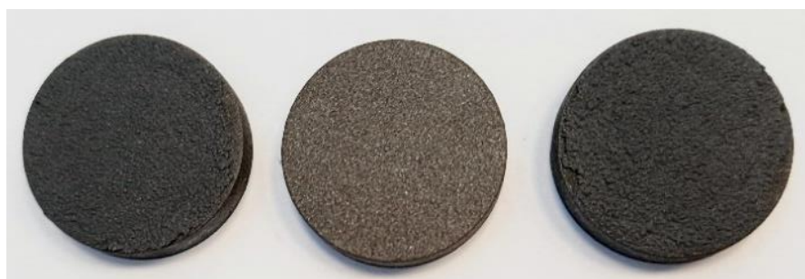
Obr. 45 Sada 220330-003 po laserovém tepelném zatěžování
