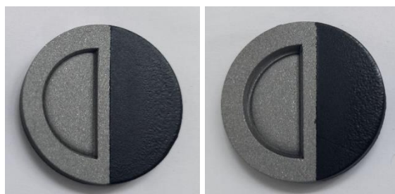
Obr. 34 Podložky na měření prášku, s drážkou 1 mm vlevo, s drážkou 2 mm vpravo
