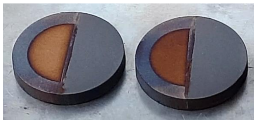
Obr. 54 Prášek 220413-003-002 (vlevo) a 220413-003-001 (vpravo) po zahřívání na teplotu 570 °C
