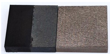
Obr. 56 Vzorek 220427-001 před tepelným zatížením (vpravo) po zahřátí na 570 °C (vlevo)
