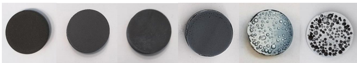
Obr. 44 Vzorky 220301-005-004 až 220301-010-004 po tepelném zatěžování v peci
