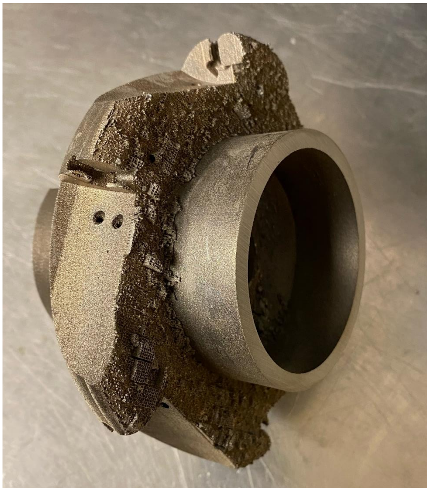
Obrázek 3-20: Fréza po 3D tisku [vlastní zpracování]
