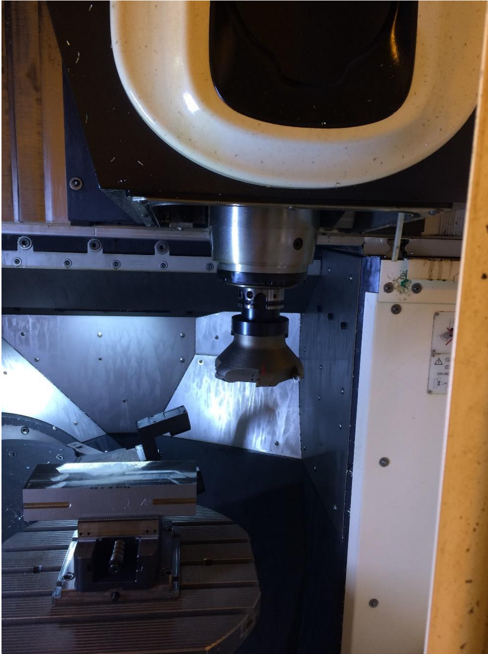
Obrázek 3-22: Fréza připravená k obrábění [vlastní zpracování]
