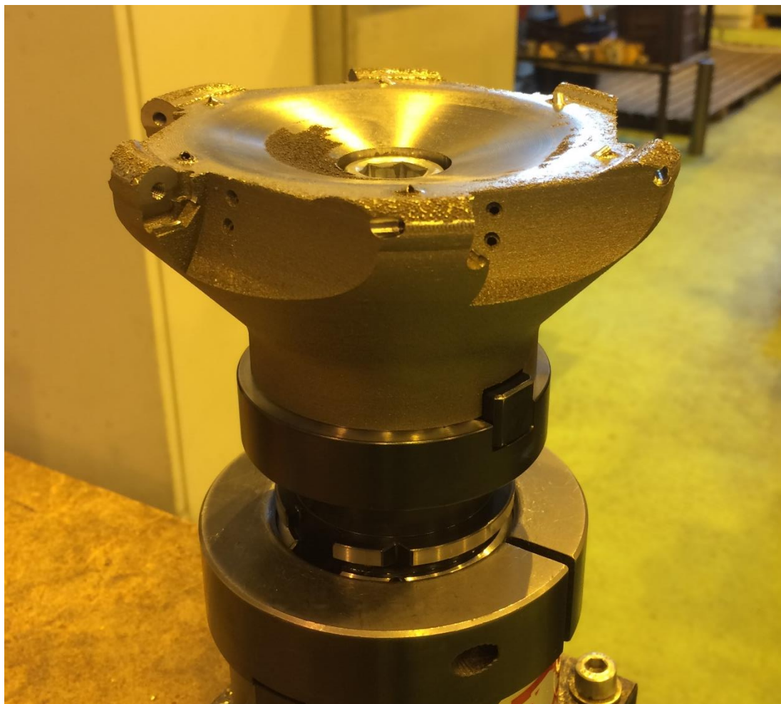
Obrázek 3-21: Fréza po obrobení funkčních ploch [vlastní zpracování]
