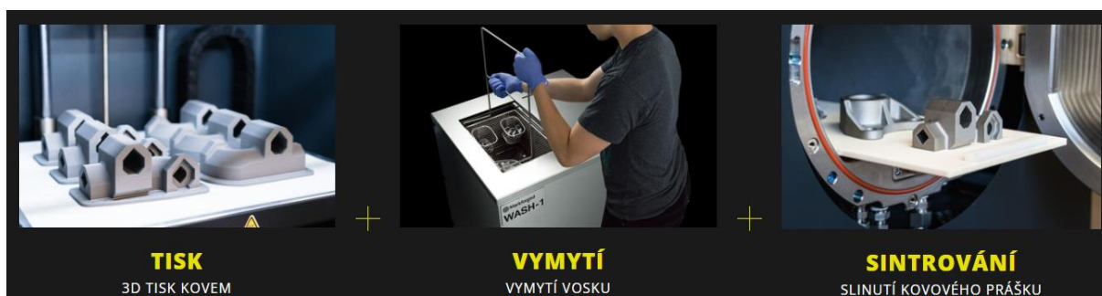
Obrázek 2-13: Znázornění technologického postupu při metodě SLS [26]
