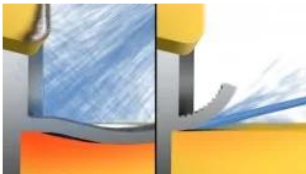
Obrázek 3-9: Přívod procesní kapaliny – zaplavení, přesný přívod [51]
