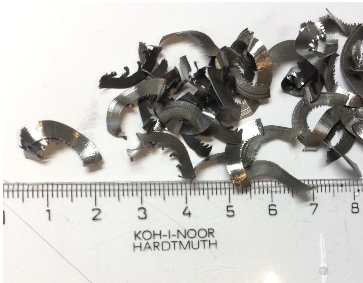
Obrázek 3-25 tříška tvořená při obrábění [vlastní zpracování]
