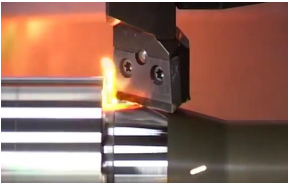
Obrázek 10: Soustružení bezšpičkovým nástrojem [19]
