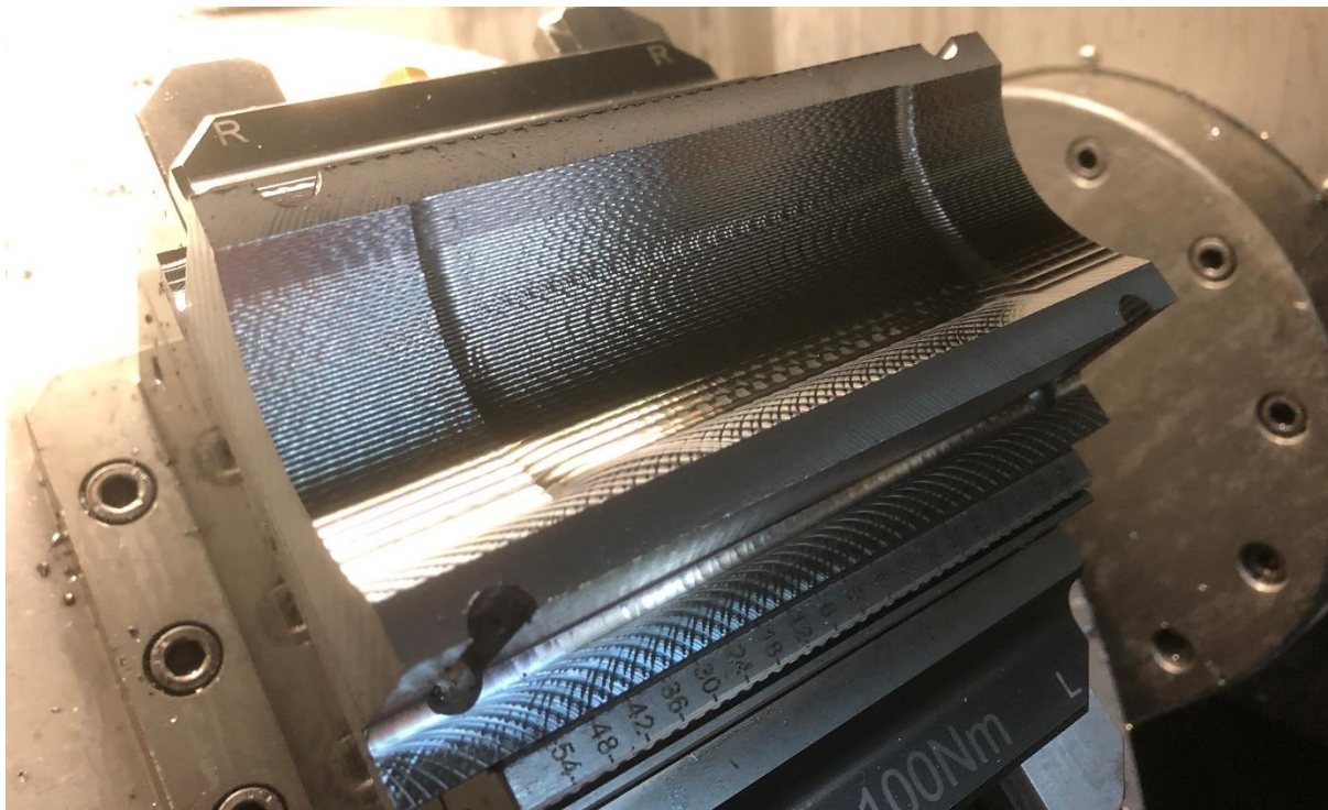
Obrázek 36: Vysokoposuvové frézování - stav obrobku po hrubování
