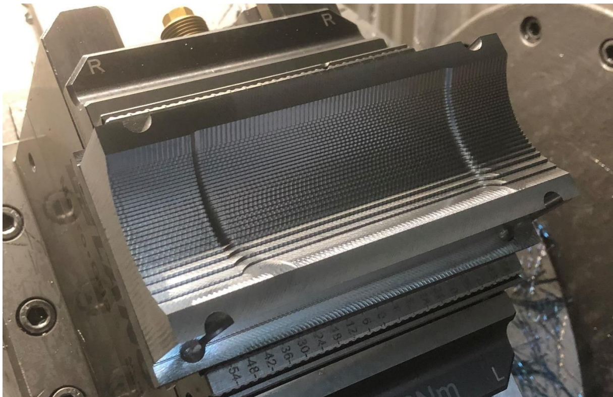
Obrázek 38: Trochoidní frézování - stav obrobku po hrubování
