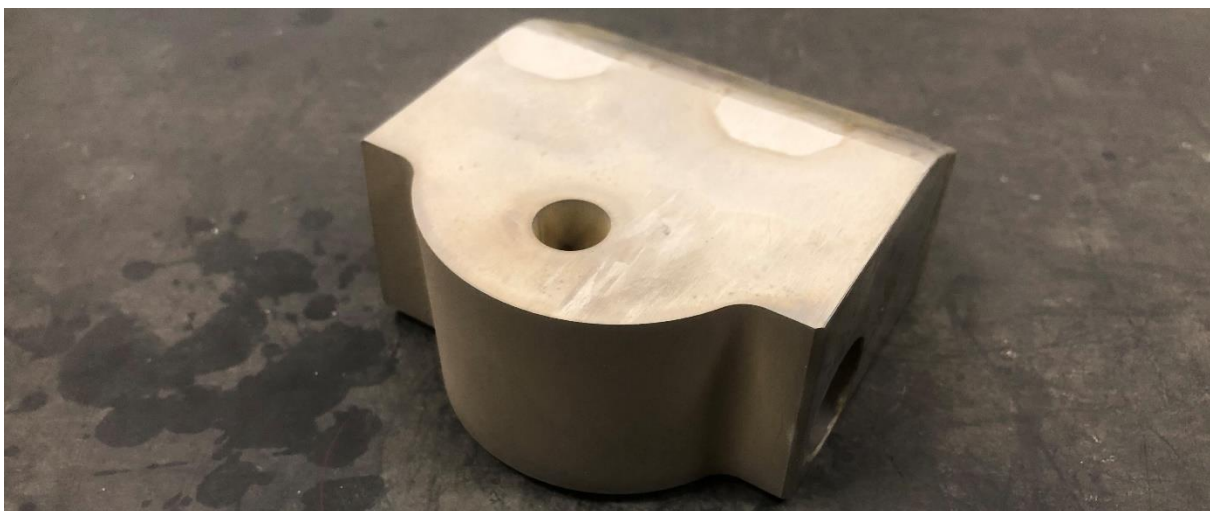
Obrázek 46: Svrchní matrice - stav po elektroerozivním drátovém řezání
