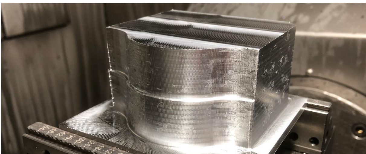
Obrázek 40: Spodní matrice - konvenční metoda, stav obrobku po hrubování
