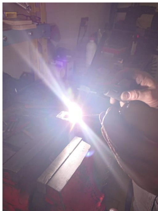
Obrázek 33 - proces navařování záslepky 3 45
