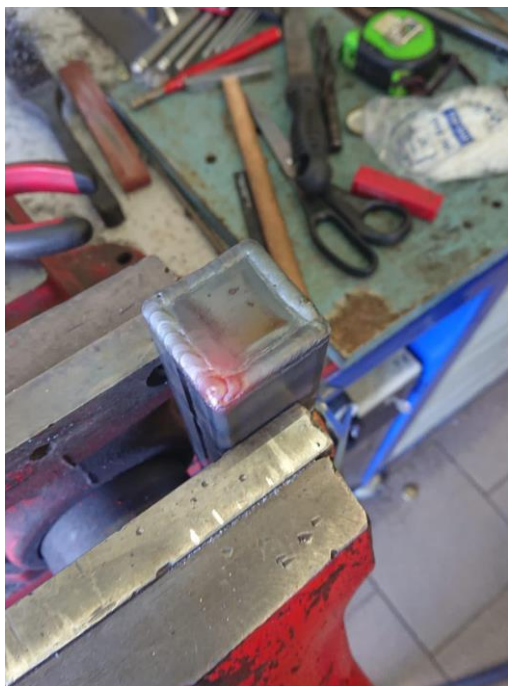
Obrázek 34 - proces navařování záslepky 46
