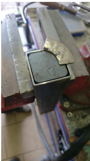
Obrázek 32 - proces navařování záslepky 2 44
