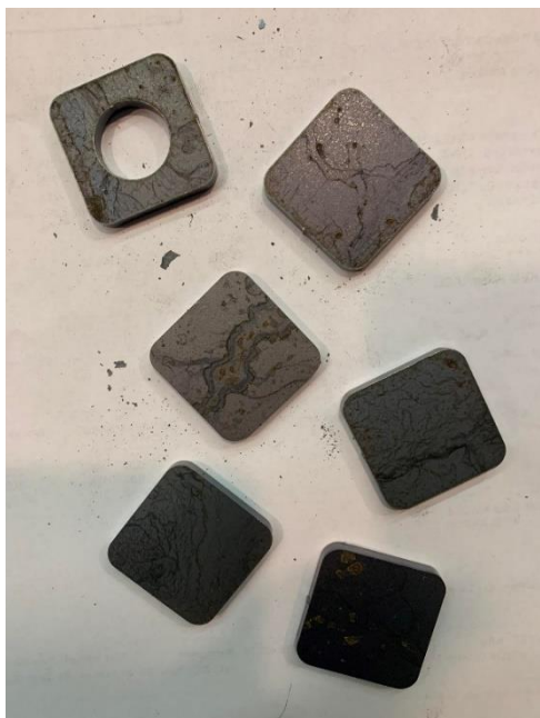
Obrázek 22 - výpalky sloužící jako záslepky 34
