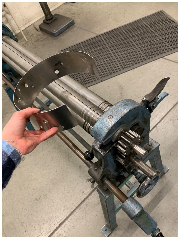
Ohýbání připraveného ocelového plátu
