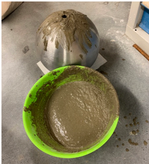
Nalévání betonu do ocelové koule
