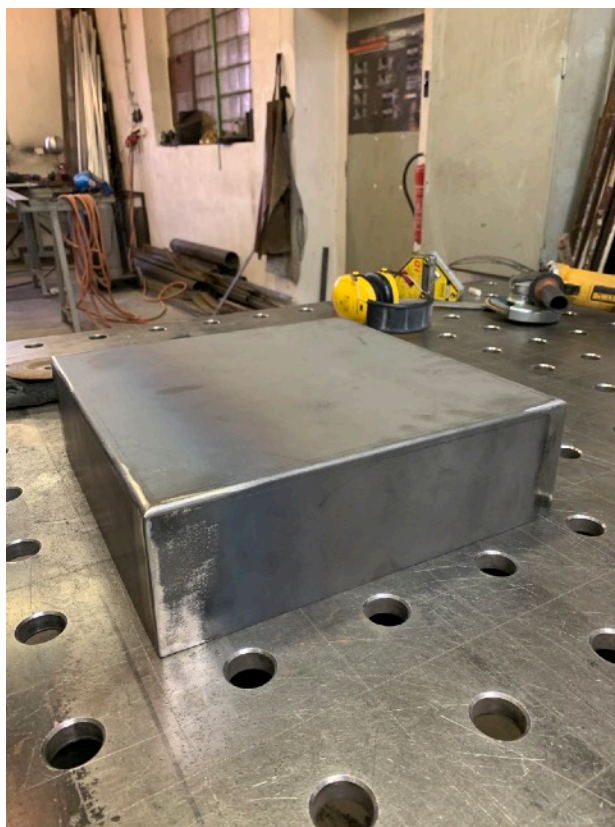
Naohýbaný plechový box se začištěnými svařenými rohy
