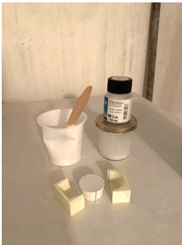
Výroba silikonového špuntu do zkumavky
