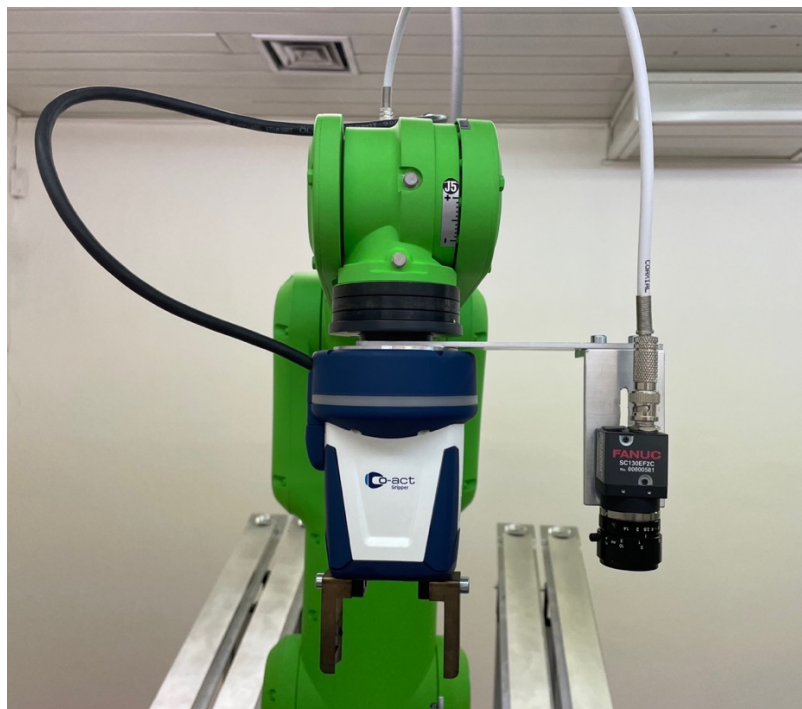
Obrázek 3.5 - Kolaborativní chapadlo a 2D kamera
