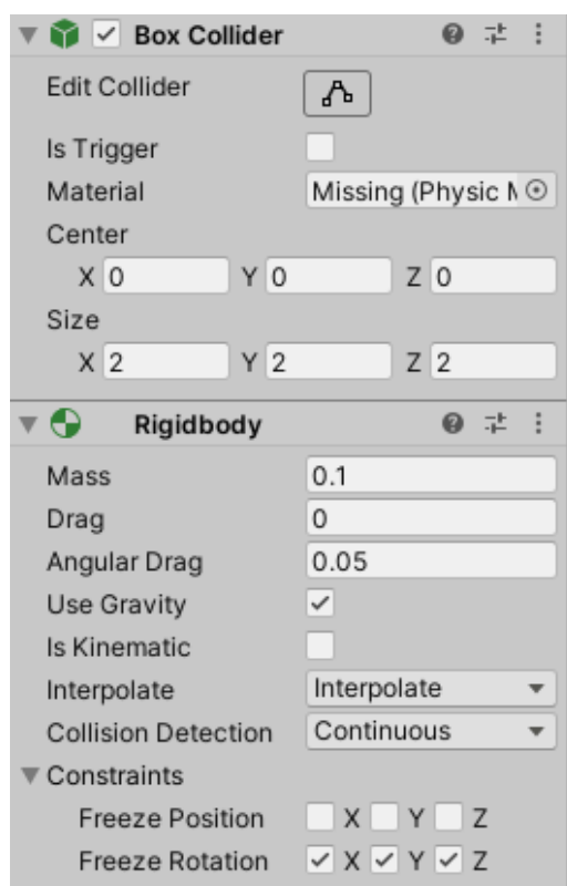
Obr. 7-16 Nastavení komponent Box Collider a Rigidbody
