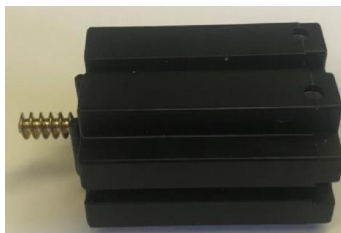
Obrázek 2-4 Mini motor Fischertechnik [12]
