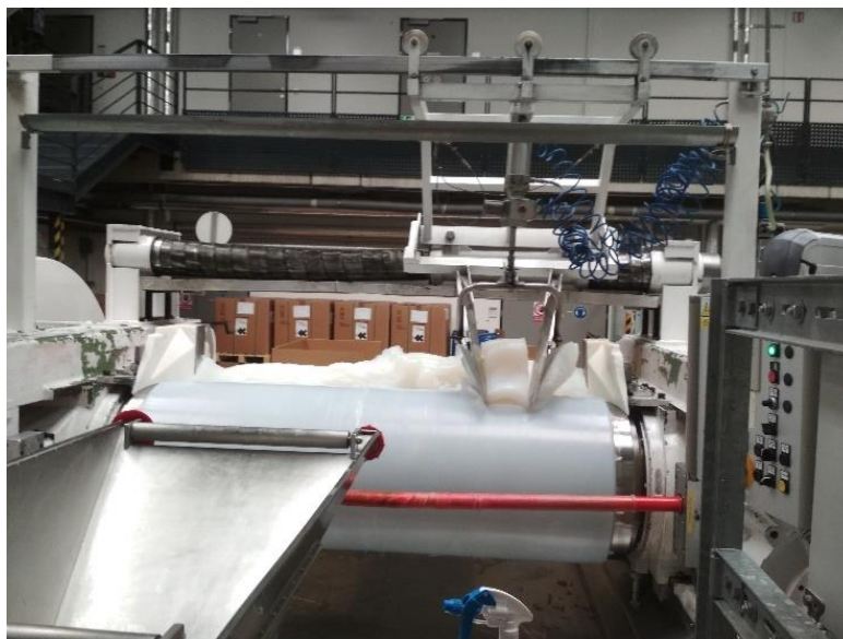
Obrázek 4-3 - Automatická míchací jednotka na válci
