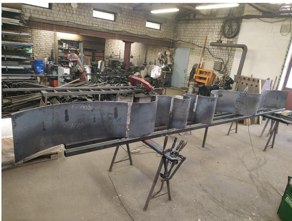
Obrázek 40, 41 : ohýbání a svaření plechu v dílně
