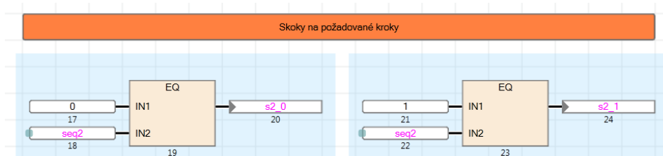
Obrázek 54: Sekvence pomocí podmíněných kroků - vyhodnocení stavů
