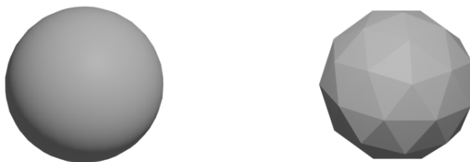
Obrázek 1.1: Koule(vlevo) reprezentovaná implicitním předpisem x^2 + y^2 + z^2 = 1 v kontrastu s koulí(vpravo) reprezentovanou trojúhelníkovou sítí
