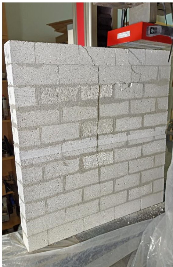
Obrázek 92: Zatížený vzorek N 41 líc
