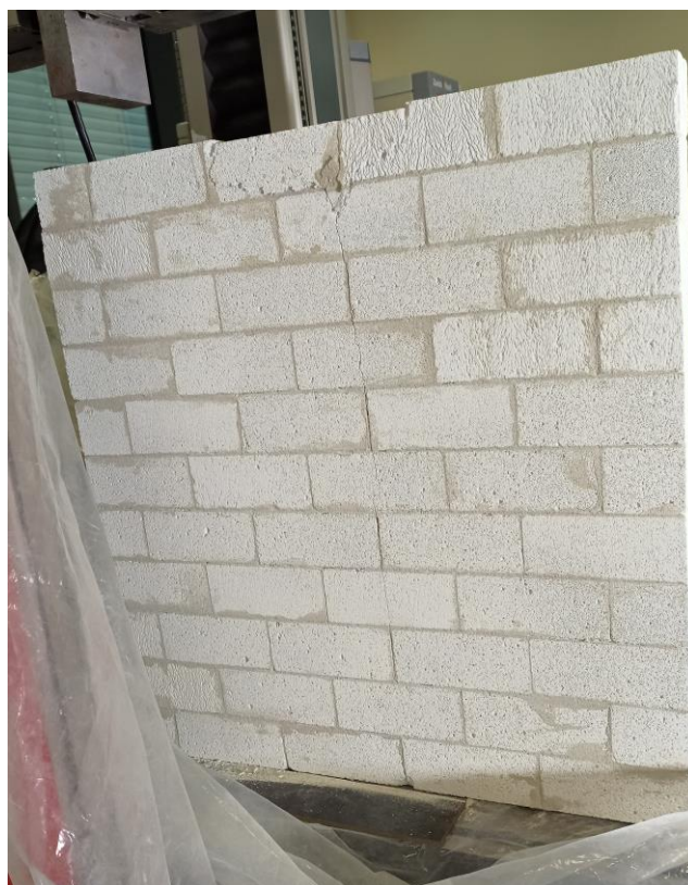
Obr. 87: Zatížený vzorek N 31 rub
