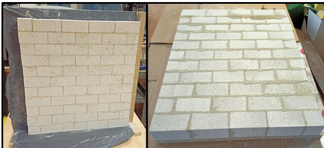
Obr. 61: Dokončený nezbrošený vzorek N_{11}
