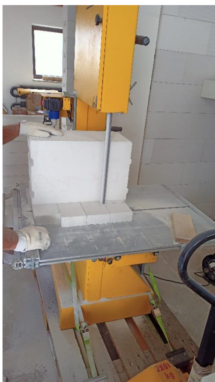
Obr. 57: Průběh řezání tvárnic
