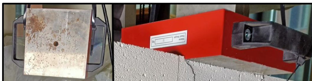
Obr. 54: Zatěžovací ocelová kostka o rozměru 170x170x46 mm váhy 11 kg
