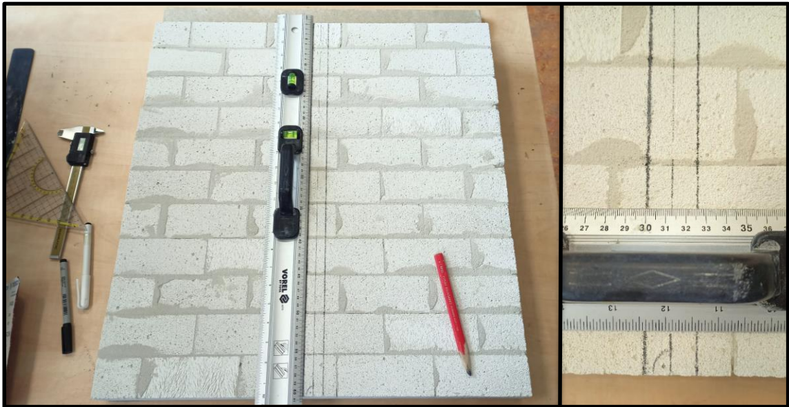
Obr. 63: Vyznačení svislé drážky na vzorku stěny N_{21} s hloubkou a šířkou drážky 26mm
