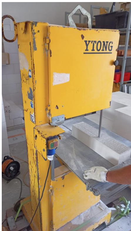
Obr. 50: Elektrická pásová pila Ytong
