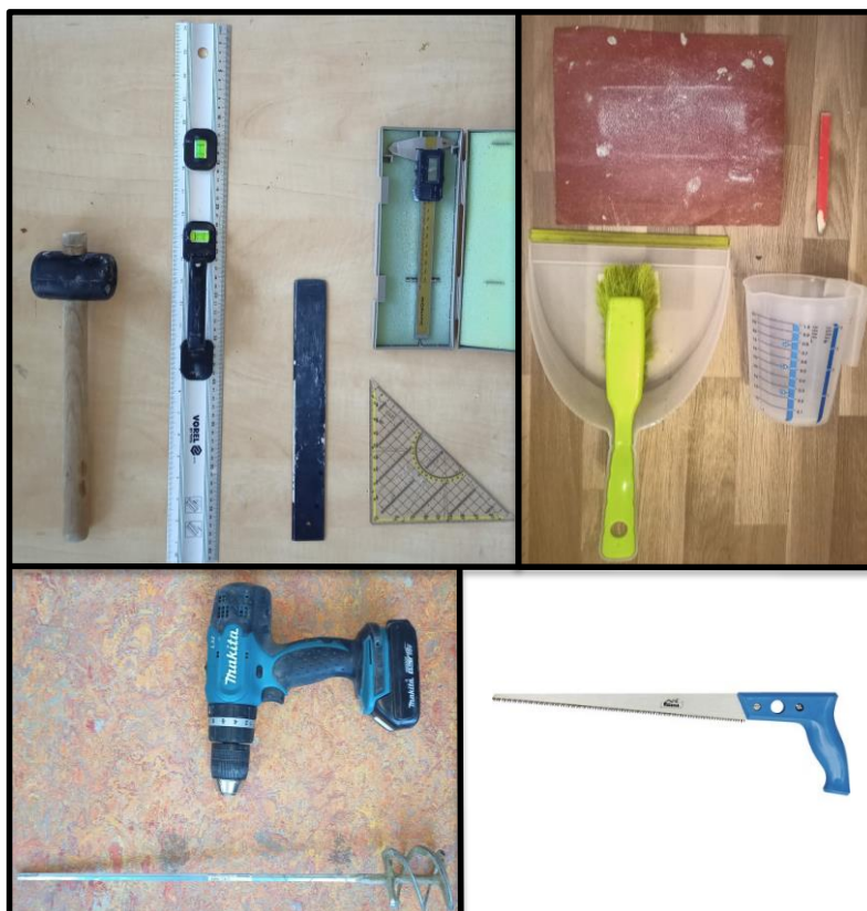
Obr. 52: Ruční nářadí a pomůcky použité při zdění vzorků
