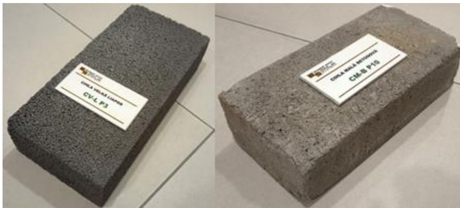
Obr. 35: Výrobky BS Group s.r.o. Klatovy, zleva cihla velká z liaporbetonu pevnosti P3 a cihla malá z hutného betonu pevnosti P10 [fotka autora]
