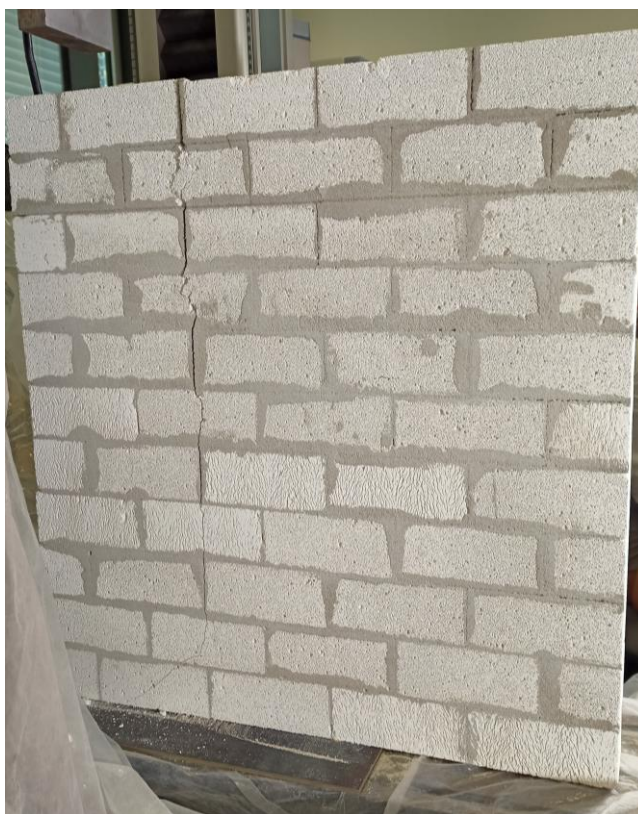
Obrázek 96: Zatížený vzorek N 51 rub
