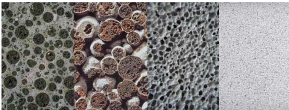
Obr. 32: Zleva hutný lehký beton, mezerovitý lehký beton, pěnobeton a pórobeton [68]
