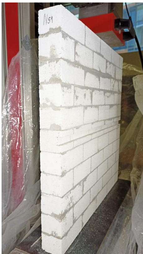
Obr. 95: Zatížený vzorek N 51 bok
