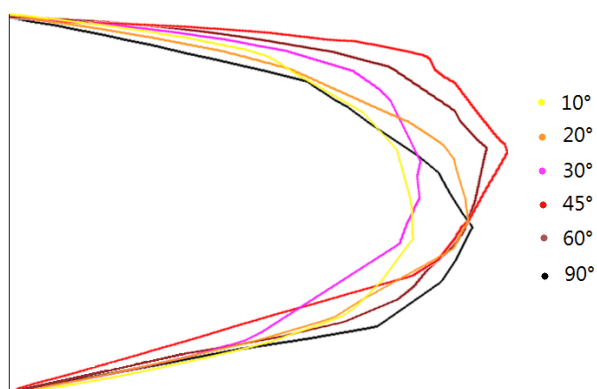
Obrázek 5.14: Rychlostní profily na výstupu2 pro jednotlivé úhly \alpha řez C
