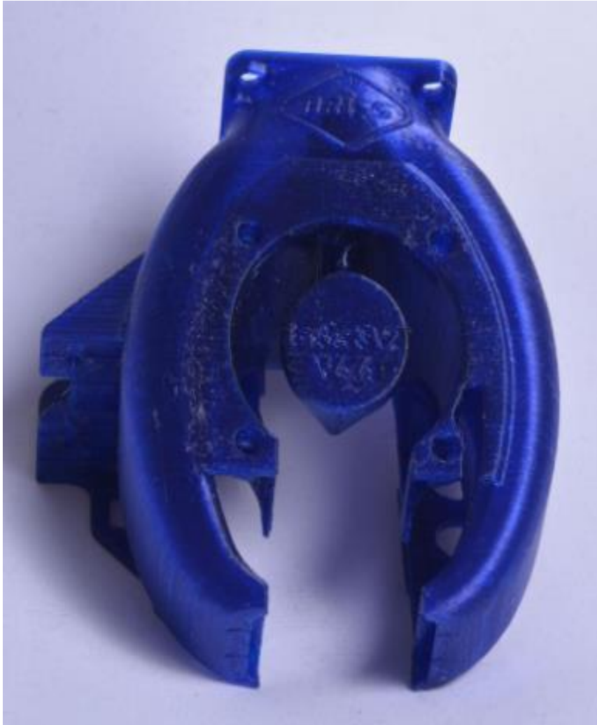
Obrázek 20: PETG –chladičí systém FANG (Zdroj: Vlastní)
