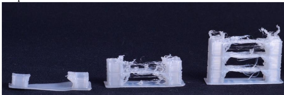
Obrázek 39: PP – zmařené teplotní věže (Zdroj: Vlastní)
