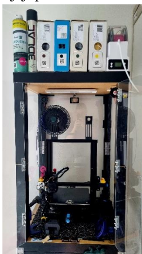
Obrázek 10: Tiskový box s tiskárnou Ender 3 V2 (Zdroj: Vlastní)
