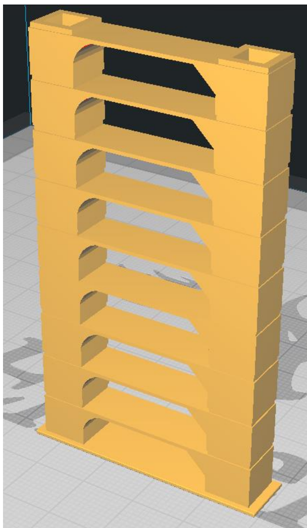
Obrázek 11: Model teplotní věže (Zdroj: Vlastní)
