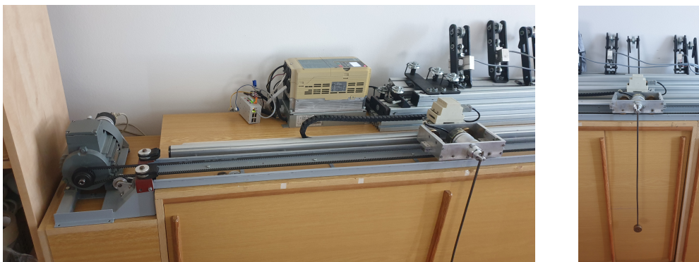
Obrázek 30: Reálný systém v laboratoři. 1. obrázek zleva - Asynchronní motor, Raspberry Pi s Monarco HAT a frekvenční měnič. 2. obrázek - reálný model kočky jeřábu s kyvadlem na pojezdu
