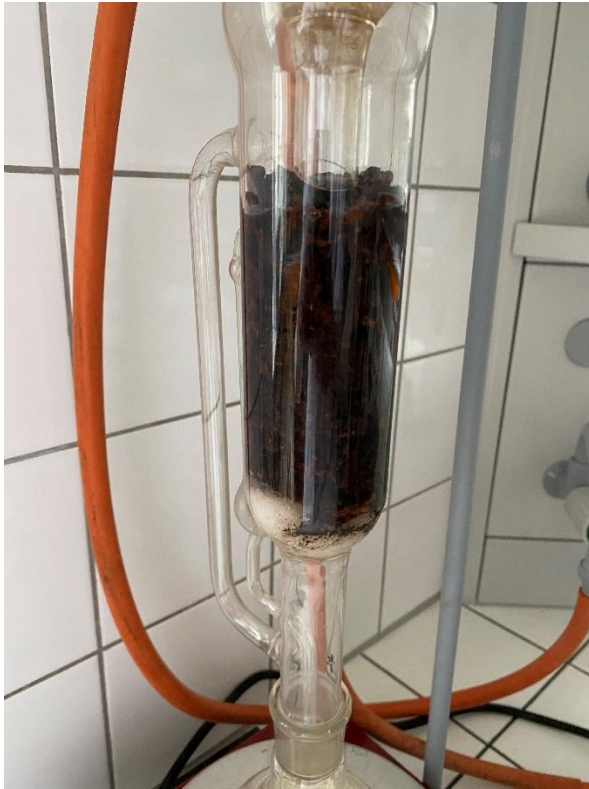
Obrázek 12: Naplněné tělo Soxhletova extraktoru vzorkem Inonotus obliquus (vata ve spodní části extraktoru brání úniku jemných částecek materiálu do baňky s rozpouštědlem).
