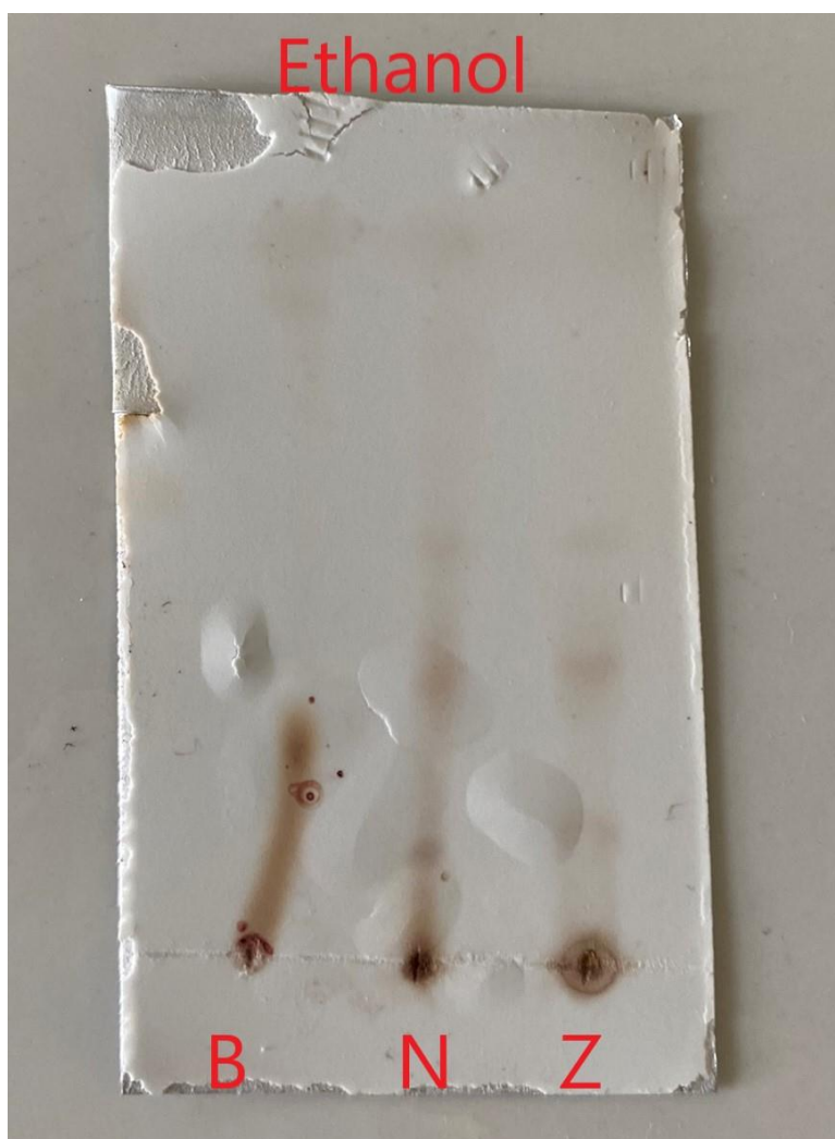
Obrázek 16: TLC ethanolového extraktu (B- betulin, N- nezmýdelněný, Z- zmýdelněný)
