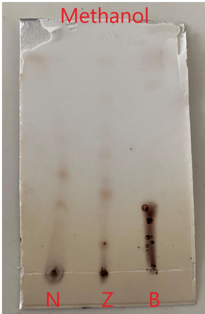
Obrázek 17: TLC methanolového extraktu (N- nezmýdelněný, Z- zmýdelněný, B- betulin)
