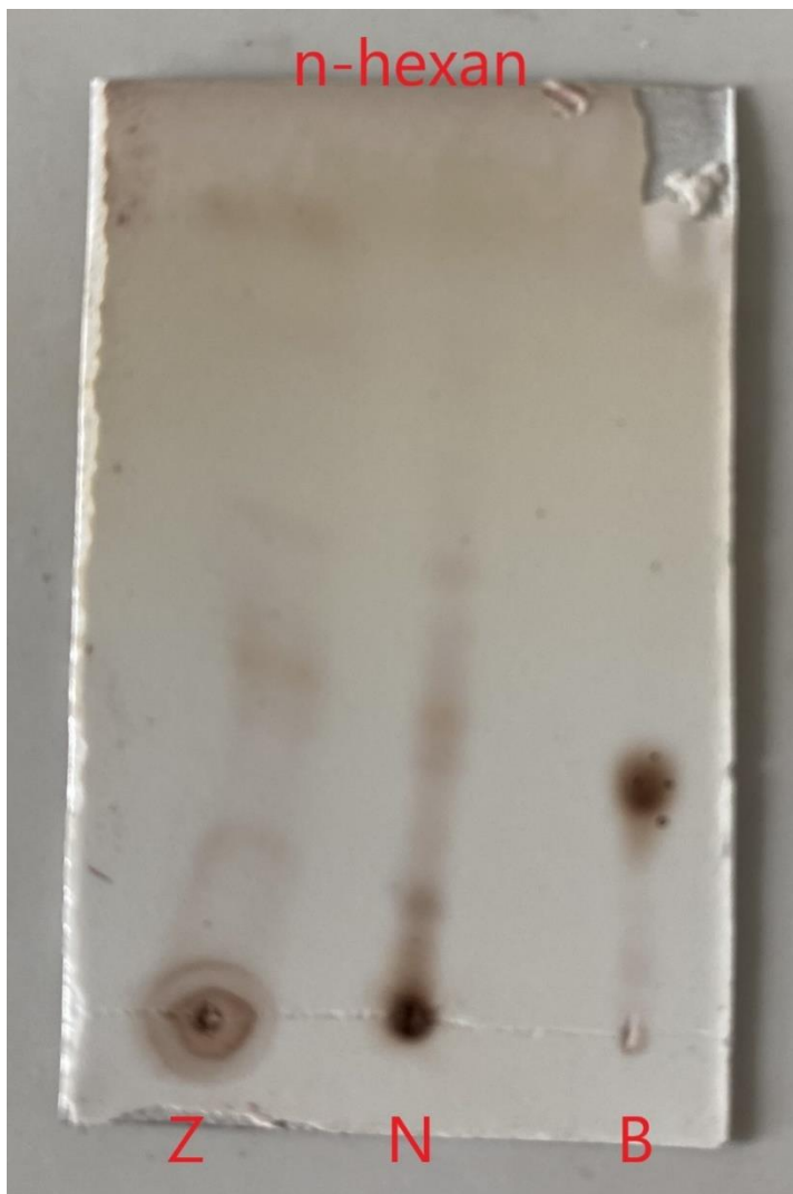
Obrázek 15: TLC n-hexanového extraktu (Z- zmýdelněný, N- nezmýdelněný, B- betulin)
