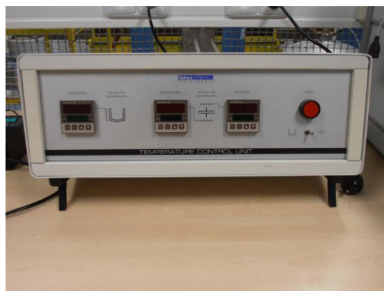
obr. B 3: kondenzátor s vyhřívánými elektrodami (vlevo) a teplotní regulátor (vpravo) pro měření tepelné závislosti ztrátového činitele \tan \delta
