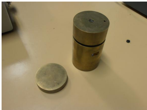
obr. B 2: elektrodový systém použitý pro měření stejnosměrných zkoušek a napěťové závislosti ztrátového činitele \tan \delta
