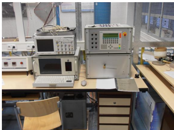
obr. B 1: počítačový měřicí systém LDV5 pro střídavé zkoušky (vlevo) a pikoampérmetr Keithley (vpravo) pro stejnosměrné zkoušky
