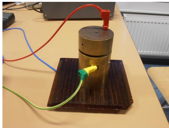
obr. B 2: elektrodový systém použitý pro měření stejnosměrných zkoušek a napěťové závislosti ztrátového činitele \tan \delta
