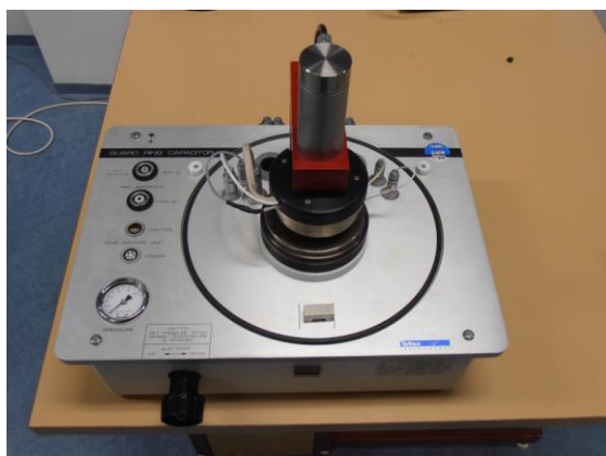
obr. B 3: kondenzátor s vyhřívánými elektrodami (vlevo) a teplotní regulátor (vpravo) pro měření tepelné závislosti ztrátového činitele \tan \delta
