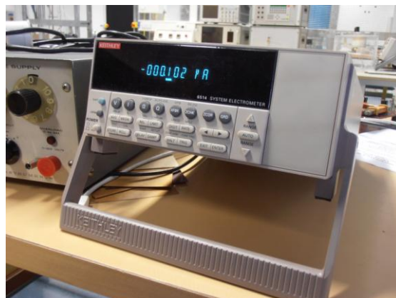
obr. B 1: počítačový měřicí systém LDV5 pro střídavé zkoušky (vlevo) a pikoampérmetr Keithley (vpravo) pro stejnosměrné zkoušky
