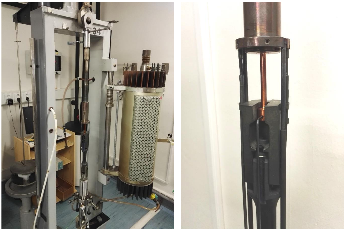
Obr. 1: Tahová sestava creepového stroje s adaptací zařízení pro měření AE
