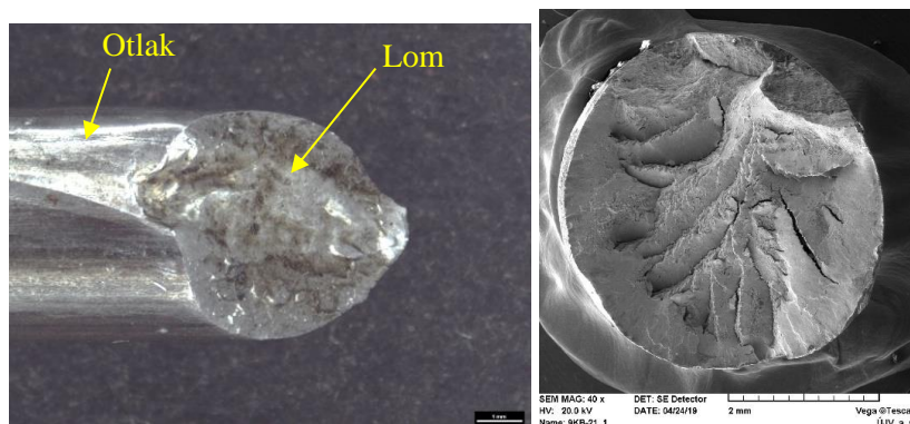
Obr. 5: Lom drátů po stendové zkoušce: a) lom s otlakem, stereomikroskop, b) lomová plocha, SEM [11]
