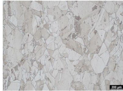
Obr. 3: Mikrostruktura austenitické nerezavějící oceli 08Ch18N10T v nezářeném stavu při různých zvětšeních (nežiháno, neleptáno)
