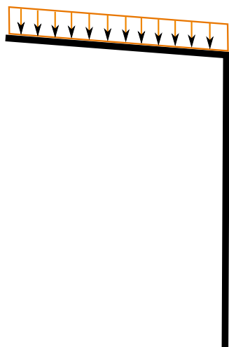
Obrázek 3.7: Zatížení vlastní tíhou
